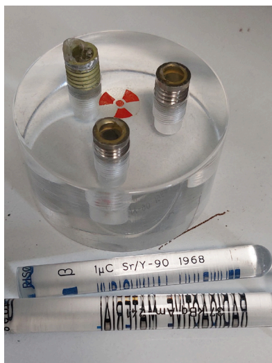
Risøkilder med knækket plexiglashåndtag. Dette kan evt. pålimes mens stumpe står i plexiglasfoden. Af årstallet fremgår dog, at beta- og gamma-kilderne nok er noget trætte.
