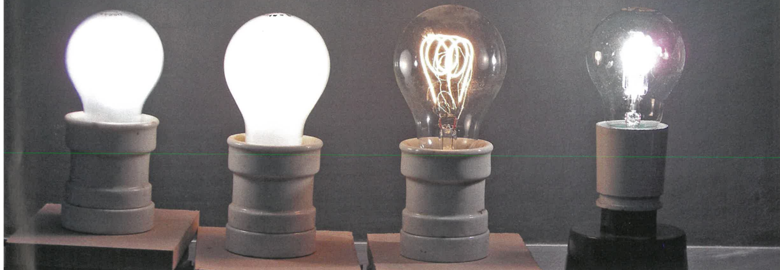
Fra venstre: Nr 1: krystalpære mat, 28 watt, lyser som 40 watt. Nr 2: alm mat glødelampe, 40 watt. Nr 3: Edisons kultrådslampe, 60 watt. Nr 4: 42/60 watt, klar krystallampe. Kameraet kunne slet ikke følge med, da alt lys er koncentreret i halogenlampen.
