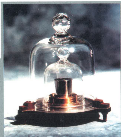
Foto af den danske kilogram-prototype. Bemærk den dobbelte glasklokke, som forhindrer at loddet forurenes af mikroskopiske partikler i luften, når det ikke er i brug. Kilde: Dansk Fundamental Metrologi A/S.
