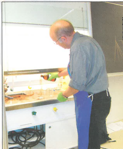
▲ Der blandes reagenser til nylon fremstilling
