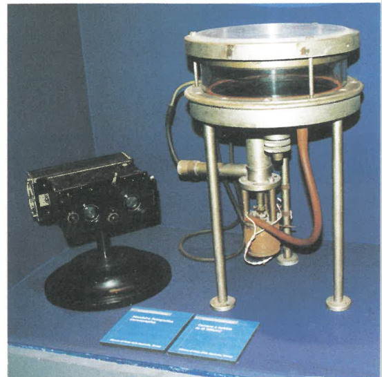
Fermis originale tågekammer samt stereo kamera, hvormed han opnåede en slags 3-D virkning i sine billeder af forsøgene.
