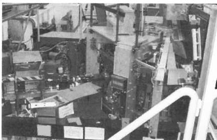
Denne lille tokamak har skaffet forskerne ved FOM deres viden om driftsbetingelserne, der sikrer lavt energitab.
