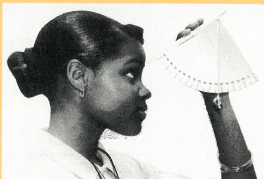
„En vinkelmåler fremstillet af enkle materialer fungerer som „astrolabium“ - et klassisk astronomisk instrument. Brugt i undervisningen kan det bl.a. anskueliggøre parallakse-måling. Copyright: TBP.“
