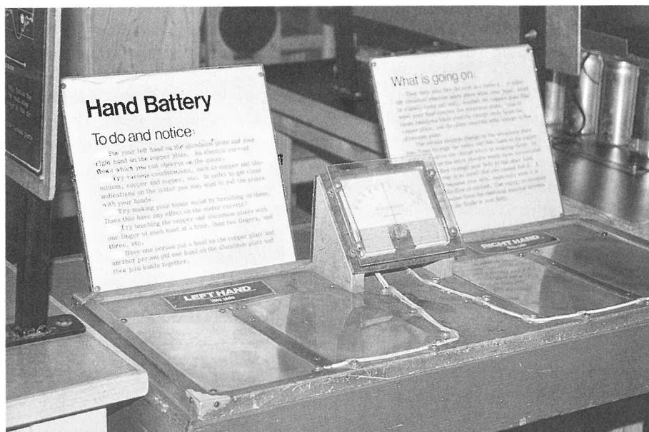
Et »hånd batteri« - d.v.s. et galvanisk element, hvor man skal lægge hænderne på to forskellige stykker metal her Zn og Cu. Exploratorium i San Francisco.
