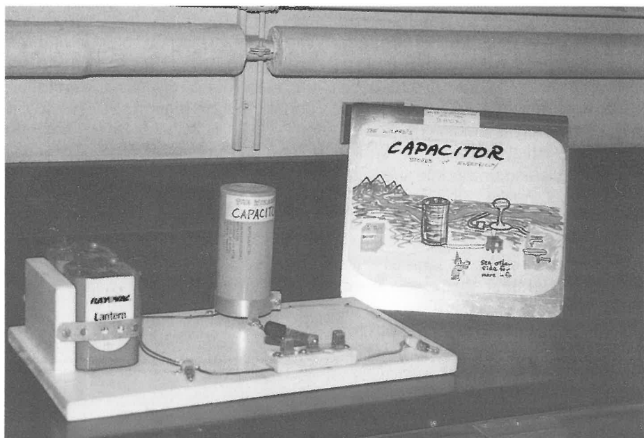
Simpel opstilling til at demonstrere en kondensators funktion. Fra det arbejdende fysiklaboratorium i Lawrence Hall of Science i San Francisco.
