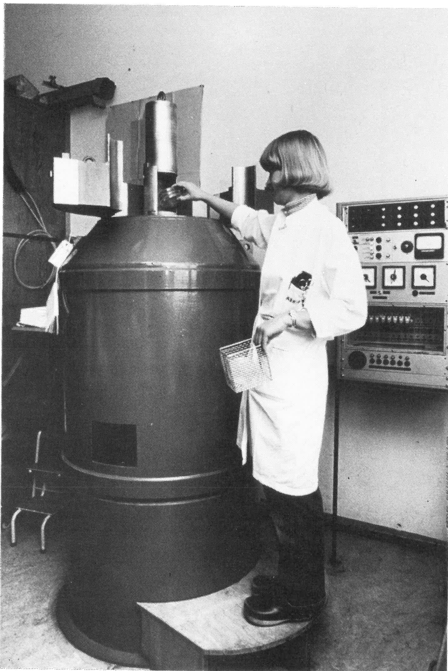
Mindre prøver kan bestråles i Risø's Gamma-celle, der indeholder 3000 Curie Kobolt-60 ( 1.1 \cdot 10^{14} Becquerel).
