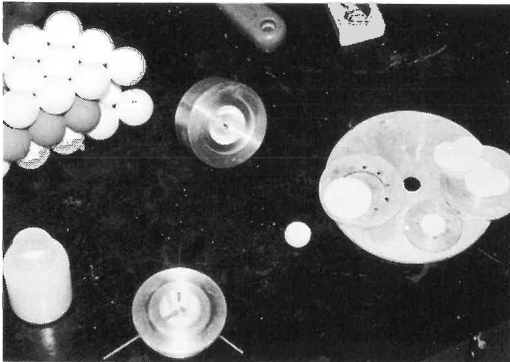
Værktøj til fremstilling af polystyrenkugler til molekylmodeller
