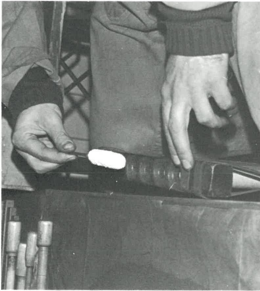
Fig. 5 Pibeler fyldes i romerlys til bund
