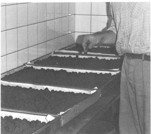
Fig. 2 Tørring af stjerner til lyseffekter
