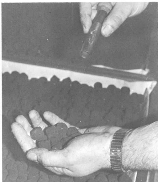
Fig. 1 Fremstilling af stjerner til lyseffekter
