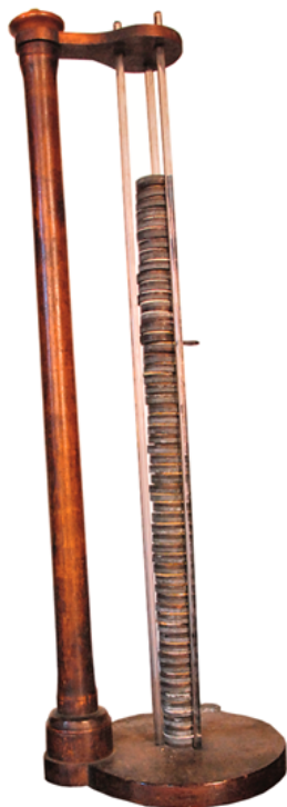
Voltasøjle bestående af en søjle af to gange ca. 60 kobber- og zinksiver adskilt af papskiver vædet med en saltopløsning, 1802. Herlufsholm Skole.
